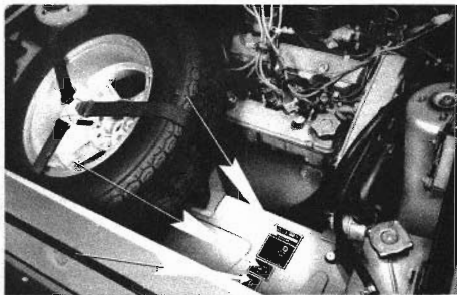
Posizione stampigliatura e targhetta per l'identificazione della vettura. Position de l'estampillage et de la plaquette pour l'identification de la voiture. Position of the stamping and plate for the identification of the car. Position der Einstanzug und des Schildes mit den Kenndaten des Wagens.
